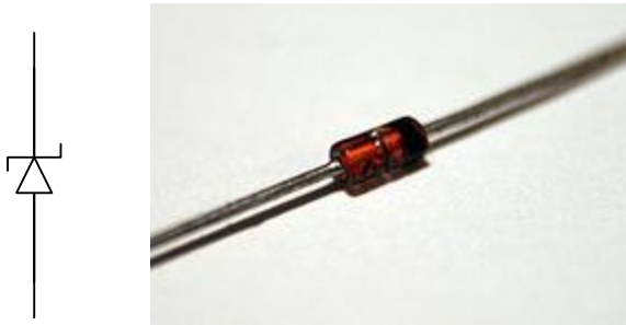
รูปที่ 4.2 สัญลักษณ์และรูปร่างหน้าตาของซีเนอร์ไดโอด
